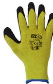
**Tejido:** Algodón y poliéster. **Recubrimiento:** Látex texturado (palma y dedos). **Descripción:** Guante de algodón combinado con poliéster, bañado en látex rugoso. Su recubrimiento resiste líquidos, alcoholes y acetonas. Su tejido brinda cierta absorción a la transpiración. Posee muy buena resistencia al desgarro.
