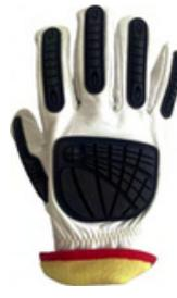
**Material:** Cuero vaqueta hidrofugado. **Resistencia al corte:** Nivel D. **Descripción:** Guante de vaqueta medio paseo hidrofugado (impermeable). Es resistente a impactos gracias a sus insertos de TPR. Posee un forro interno de Kevlar que le brinda resistencia al corte nivel D. El cuero es flexible y confortable, brindando excelente movilidad en la mano. Color blanco perlado.
