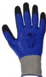
**Tejido:** HPPE. **Recubrimiento:** Doble baño de nitrilo (liso completo, arenoso en palma y dedos). **Resistencia al corte:** Nivel D. **Descripción:** Guante de polietileno de alta densidad. El baño completo de nitrilo liso le otorga impermeabilidad. El baño de nitrilo arenoso brinda buen agarre en superficies húmedas. Resistente a derivados del petróleo.
