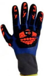
**Tejido:** Poliéster. **Recubrimiento:** Doble baño de nitrilo (liso completo, arenoso en palma y dedos). Insertos anti-impacto de TPR. **Descripción:** Guante tejido de poliéster con doble baño de nitrilo. Sus recubrimientos le brindan impermeabilidad y excelente agarre. Resiste impactos gracias a sus insertos de TPR. Resistente a derivados del petróleo.
